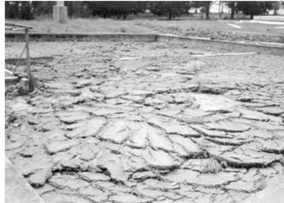
La forma de operación consiste en el llenado de los lodos en capas no superiores a los 30 cm. Además de la filtración por gravedad existe una pérdida importante de líquido por evaporación.
